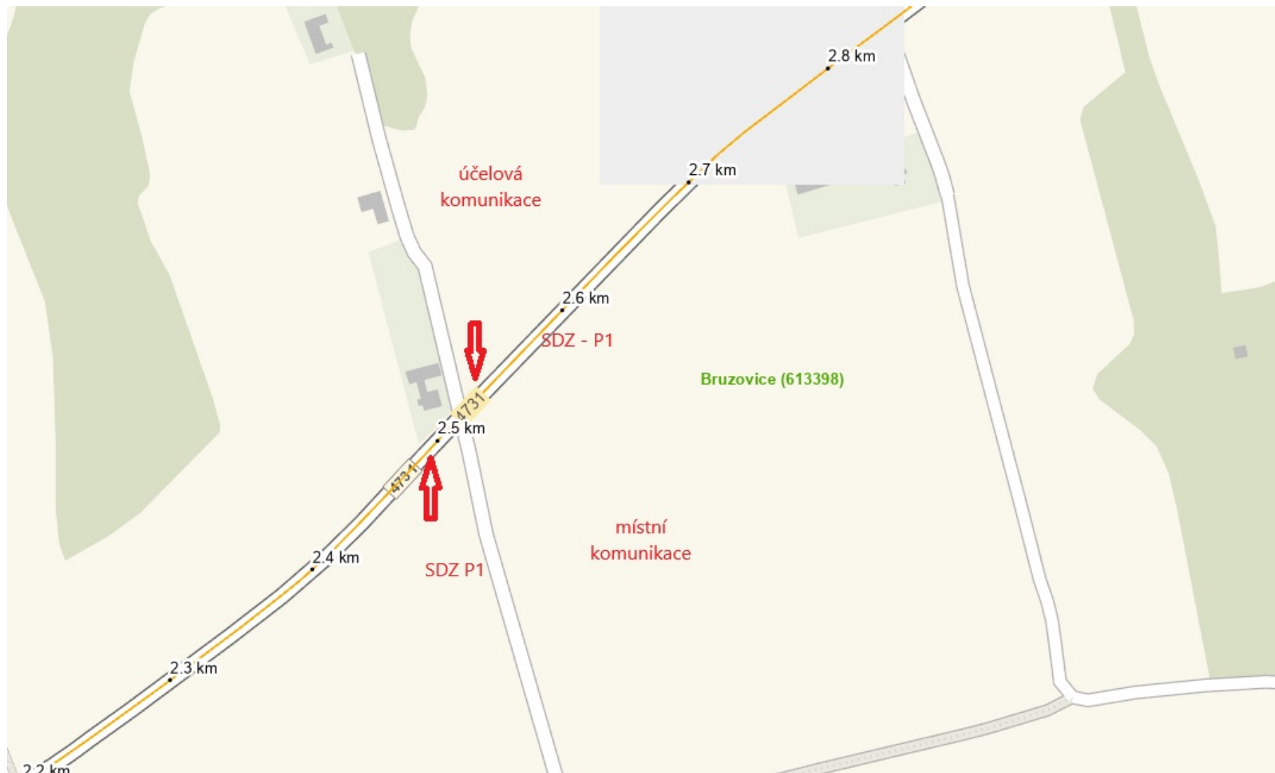
Situace na silnici III/4731 v km 2,510 - nová SDZ - P1 křižovatka v obou směrech
