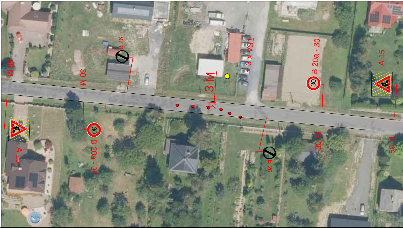
VZOROVÉ PRACOVNÍ MÍSTO - POSTUPNĚ POSOUVAJÍCÍ - DOKONČOVACÍ PRÁCE - DÉLKA 30 M
